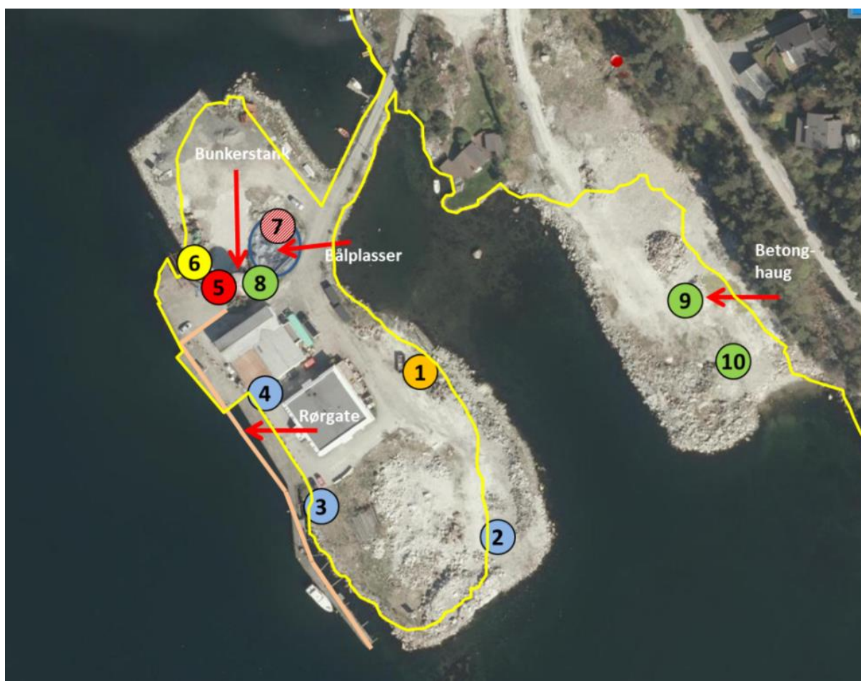
Figur 12.5. Sjaktplassering med tilstandsklasseangivelse. Potensiale for spredning av forurensning anses som høyt ved sjakt 1, 5 og 7.
